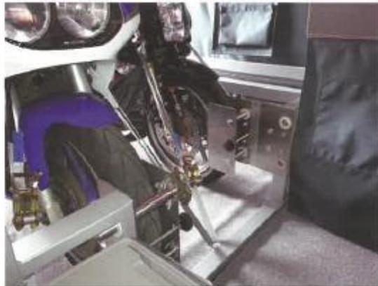
Für eine sichere Befestigung der gesamten Fracht ist durch die zertifizierte Ladungssicherung an der Rahmenkonstruktion des Moduls gesorgt. Somit bietet der Rahmen des Freizeitmoduls natürlich auch außerhalb des Freizeitvergnügens Ladungssicherungsmöglichkeiten für unterschiedliche Transportanforderungen.
